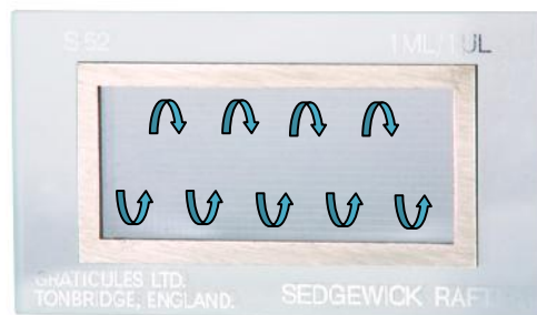
Fig.4. Lectura para el conteo de rotíferos en la cámara de Sedgwick Rafter
